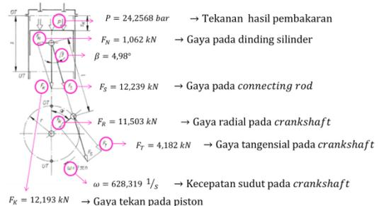
Untuk menentukan daya *starter* maka perlu dilakukan perhitungan untuk momen inersia massa dan percepatan sudut.
